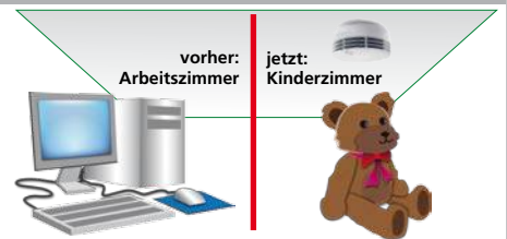
Aufgrund der Nutzungsänderung ist jetzt ein Rauchwarnmelder zwingend vorgeschrieben
